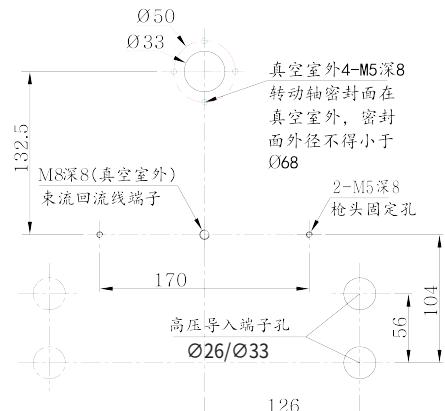
注: 高压导入端子建议放在靠近真空室壁一侧,
